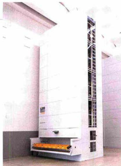
prelievo, aumentando la velocità e snellendo i processi. Inoltre, Flexibox offre scalabilità nativa: le aziende possono iniziare con una singola unità e aggiungere ulteriori moduli in base alle necessità. Flexibox consente di stoccare centinaia di cassette standard (600 x 400 millimetri) in spazi estremamente ridotti. Inoltre, è possibile sfruttarne al massimo l'altezza, fino a 20 metri.
