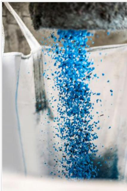
Subito dopo, **un'accurata selezione per tipologia di polimero** è fondamentale per garantire la qualità del pallet riciclato e la resistenza del prodotto finale; più omogeneo è il materiale di partenza, meglio avverrà il riempimento dello stampo, così da ottenere un risultato omogeneo e privo di punti deboli.
